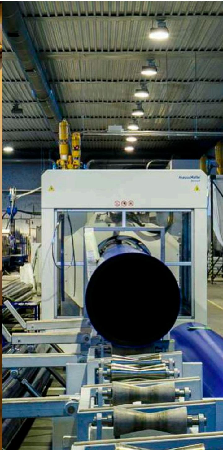
Резка труб осуществляется специальным ножом. Машина этого типа осуществляет резку без удаления материала, не оставляя стружки и пыли, а также обладает низким уровнем шума.
