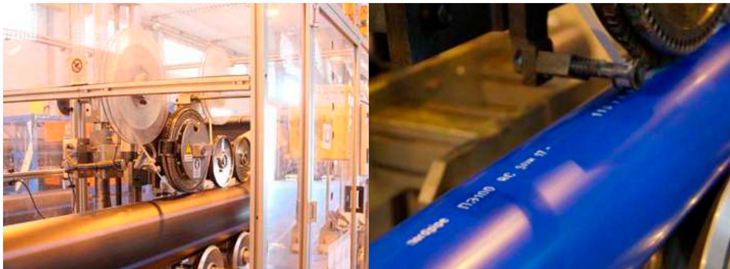
Маркировка наносится на поверхность трубы методом термотиснения с окрашиванием наносимого тиснения с интервалом не более 1 м. Маркировка не должна приводить к возникновению трещин и других повреждений, ухудшающих прочностные характеристики трубы.
